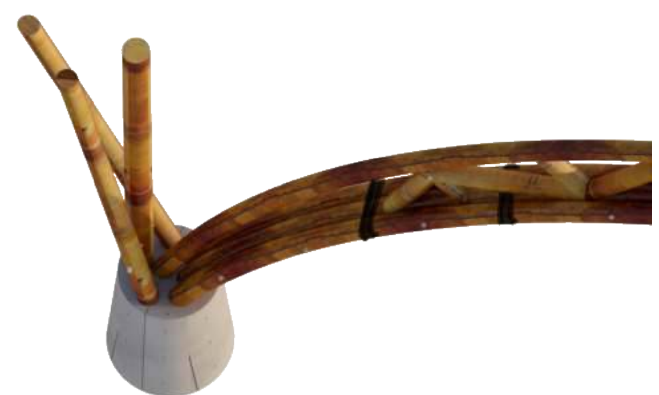
Detalle arranque de la cercha
