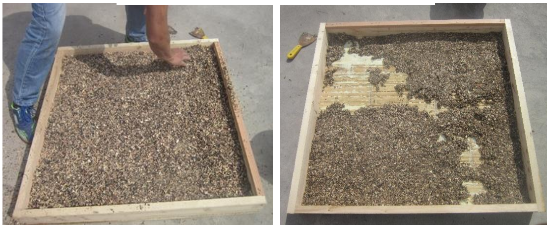
Imagen 19. Compactación de los granulados
