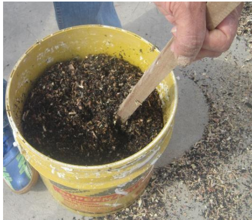
Imagen 18. Mezcla de los granulados con cauchola
