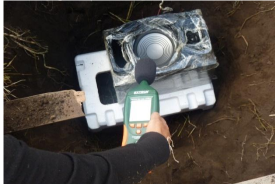
Imagen 24. Sonómetro y fuente de sonido
