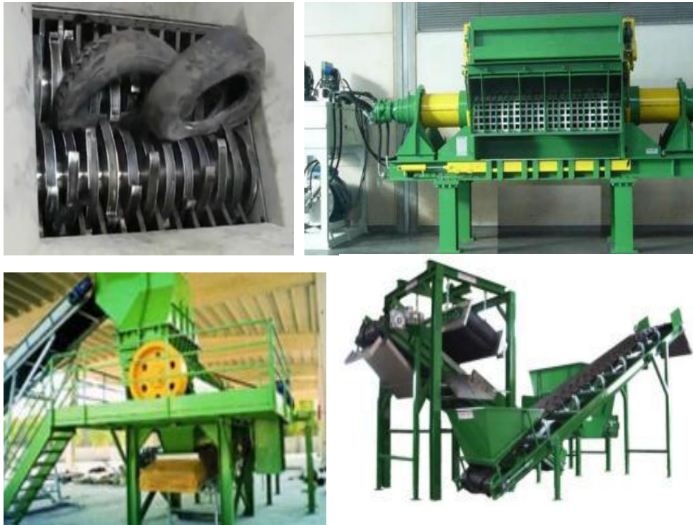
Imagen 8. Proceso de transformación de la llanta
