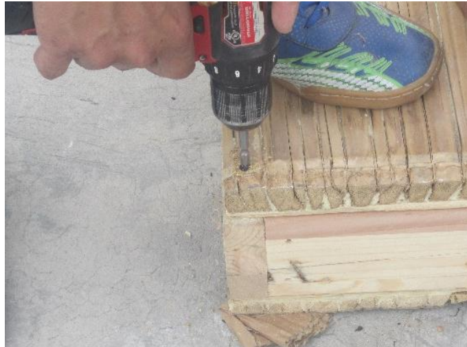
Imagen 20. Ensamblaje de las láminas de guadua
