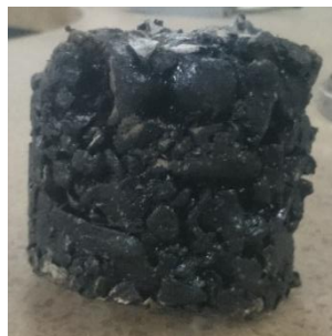
Figura 20 Deformación de la mezcla asfáltica después de la carga.
