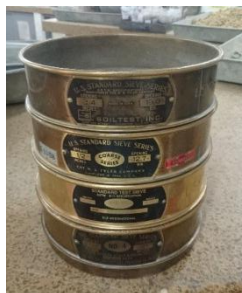
Figura 5 Tamices respectivos para la granulometría
