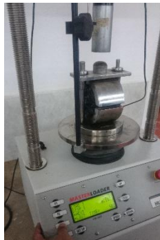
Figura 19 Mezcla asfáltica Expuesta a carga a compresión
