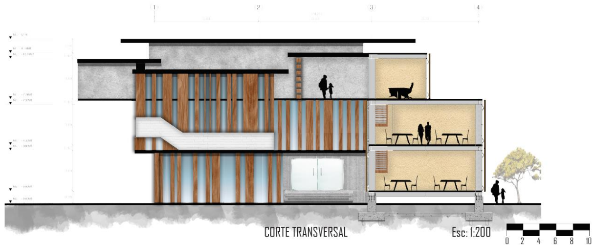
Ilustración 52. Corte transversal bloque 2
