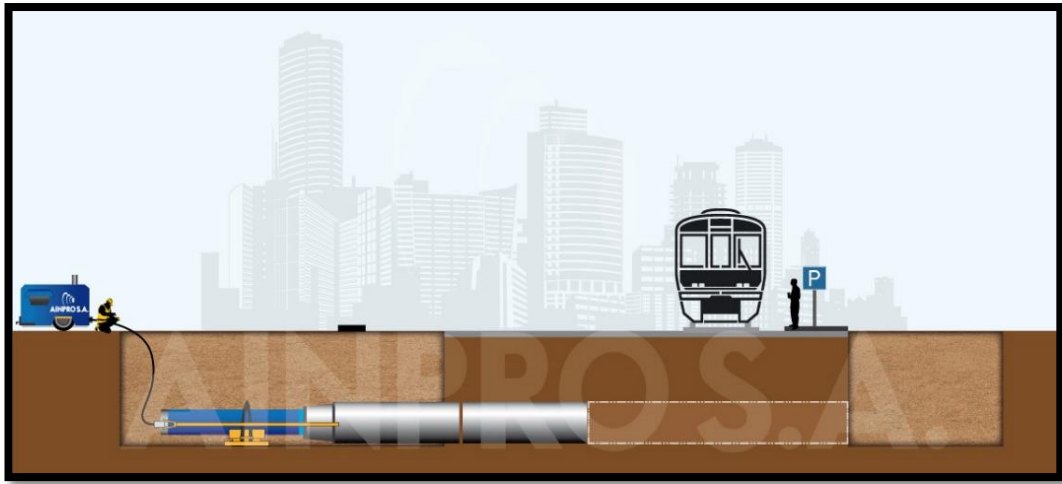
Ilustración 12 Proceso constructivo perforación horizontal por ramming
