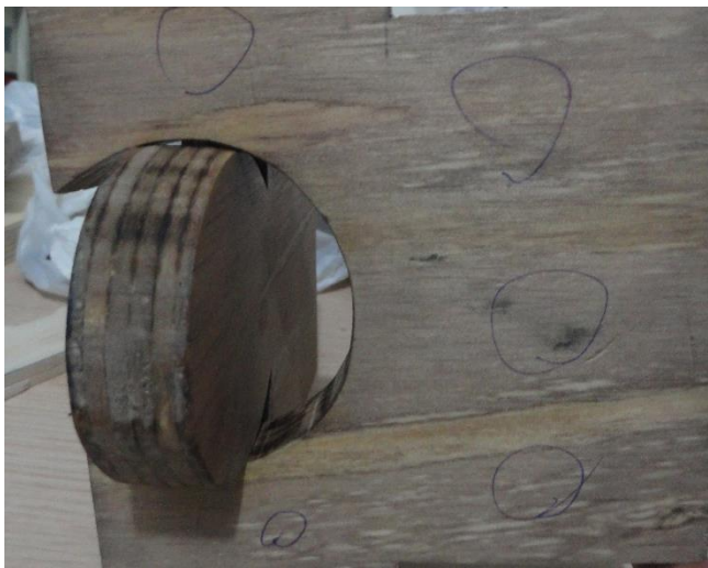
Figura 45 Elaboración propia, segundo desarrollo, colocación a 90° en madera aglomerada de 2 cm de espesor vistas exteriores
