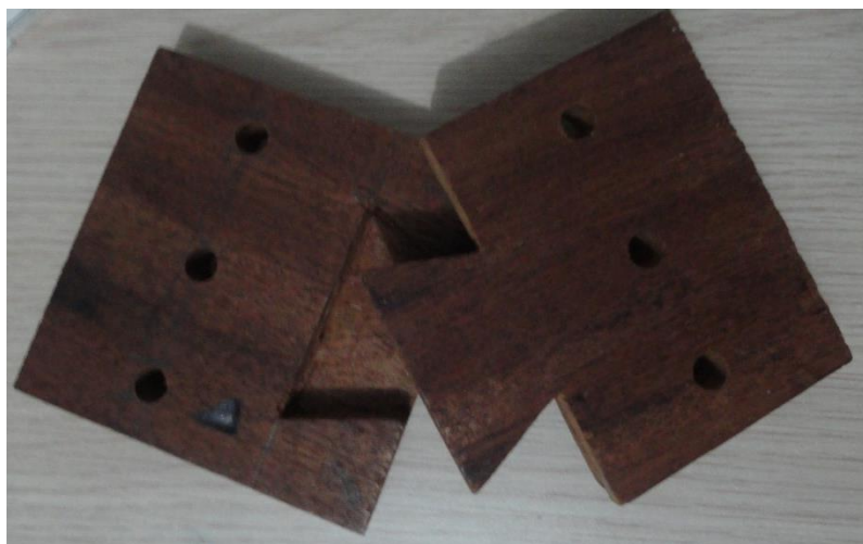
Figura 35. Elaboración propia, segundo desarrollo, Pieza con ensamble en cola de milano trapezoidal sin inglete en la pieza hembra
