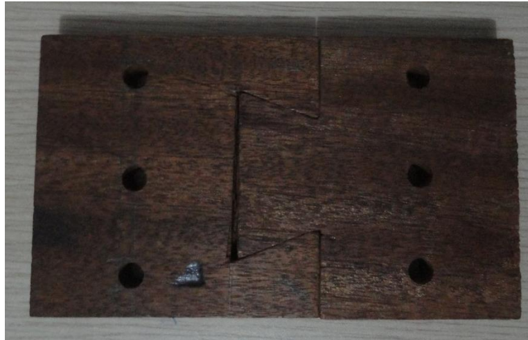
Figura 36. Elaboración propia, segundo desarrollo, Pieza con ensamble en cola de milano trapezoidal sin inglete en la pieza hembra, unión
