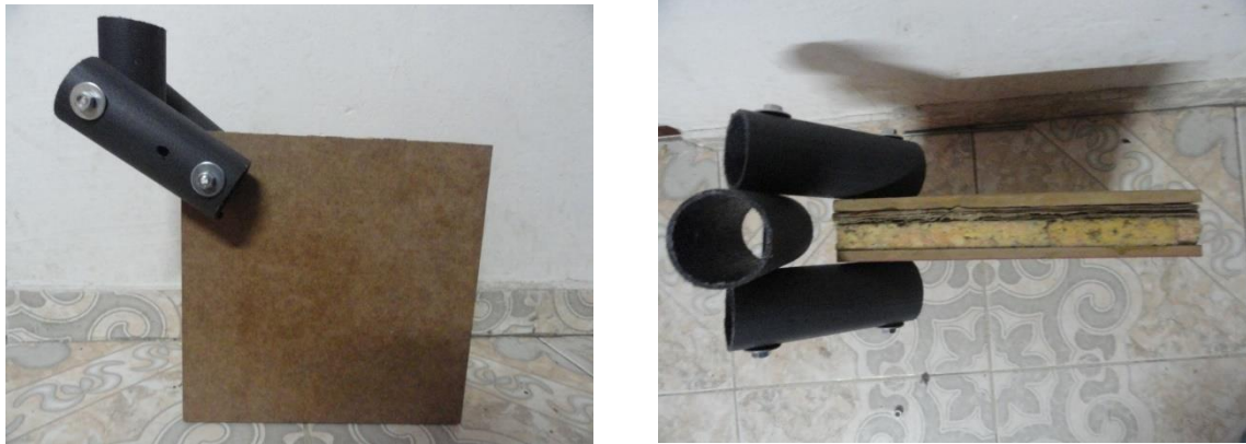
Figura 20. Elaboración propia, prototipo 1 sistema de anclaje en bambú para esquina.
