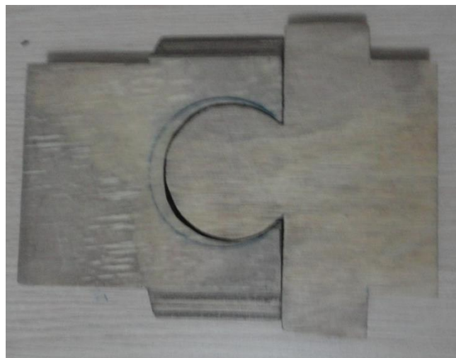
Figura 43. Elaboración propia, segundo desarrollo, colocación a 90° en madera aglomerada de 1 cm de espesor
