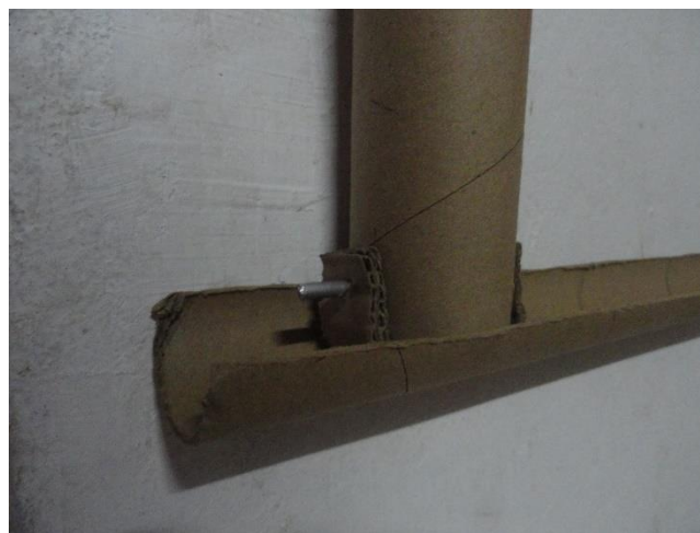
Figura 24. Elaboración propia, prototipo 2 sistema convencional de perfilaría en bambú, colocación de pasador
