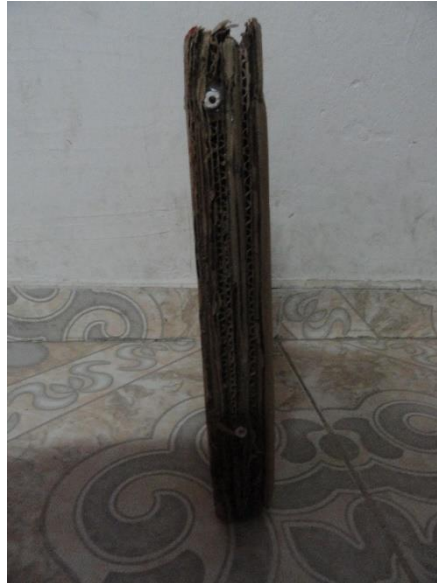
Figura 26. Elaboración propia, prototipo 3 sistema de soporte entre corte a 45°, colocación de chazos a prototipo de panel
