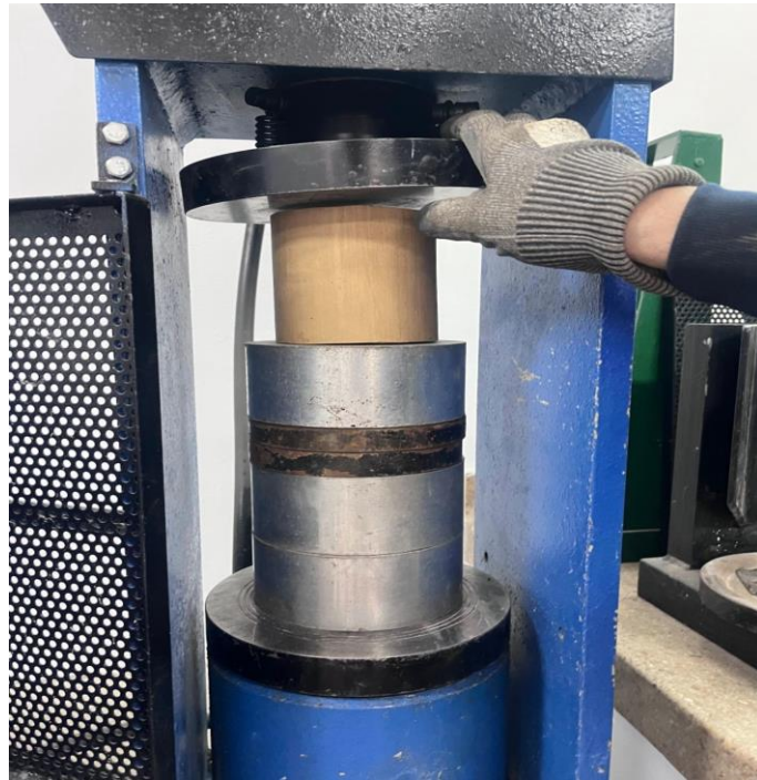
Figura 2. Ensayo de compresión en probeta de guadua.
