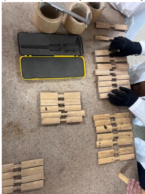
Figura 4. Recolección de probetas para ensayos de tracción y compresión.
