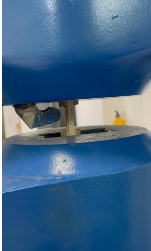
Figura 5. Ensayo de tracción en probeta de guadua.
