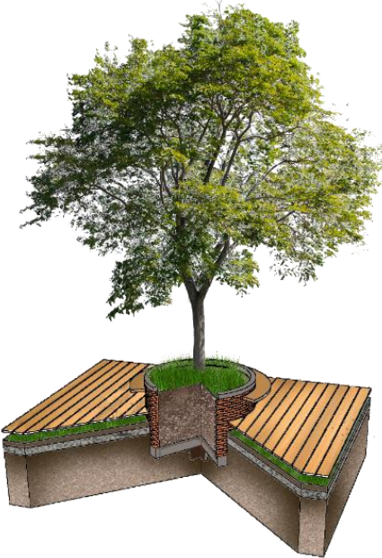
Figura 57 Detalle estructural alcorque. Elaboración propia
