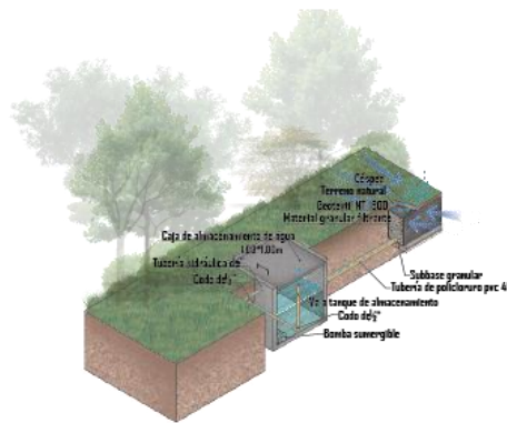
Figura 58 Detalle de recolección de agua filtro francés. Elaboración propia
