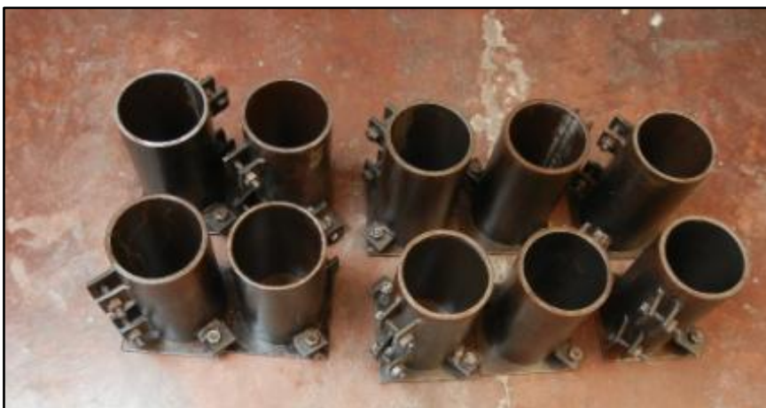
Fotografía 38. Camisas para cilindros de concreto de 4" x 8"
