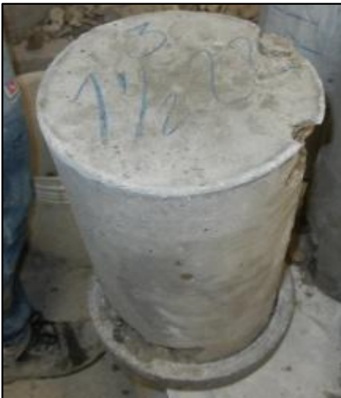
Fotografía 10. Fallas de los cilindros Muestra #3
