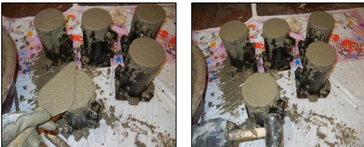
Fotografía 21. Enrace de muestra y vibrado
