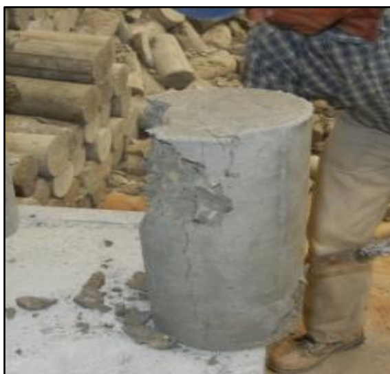
Fotografía 8. Fallas de los cilindros muestra #1
