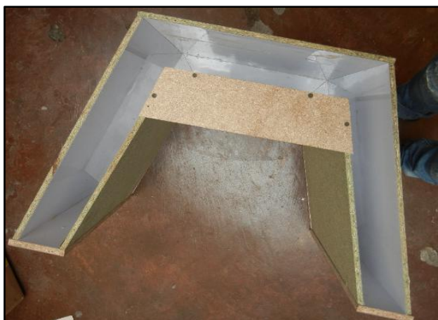
Fotografía 27. Formaleta para silla en madera RH
