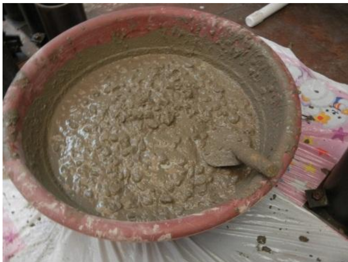
Fotografía 19. Mezcla de cemento, cascarilla de arroz, grava, arena de río y agua.
