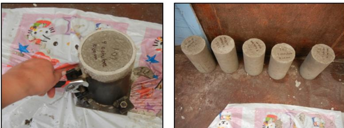
Fotografía 22. Desencofre de muestras y marcado
