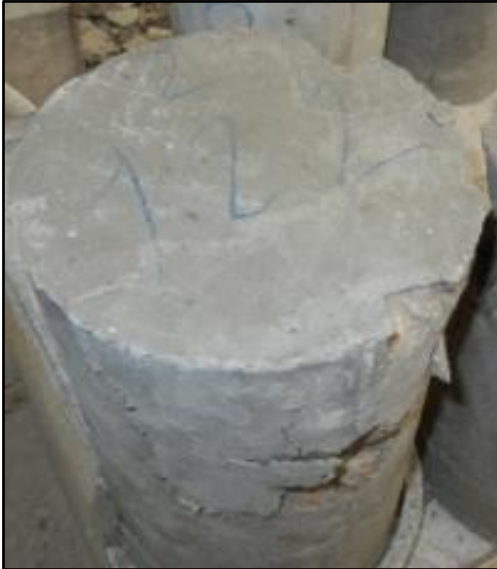
Fotografía 9. Fallas de los cilindros muestra #2
