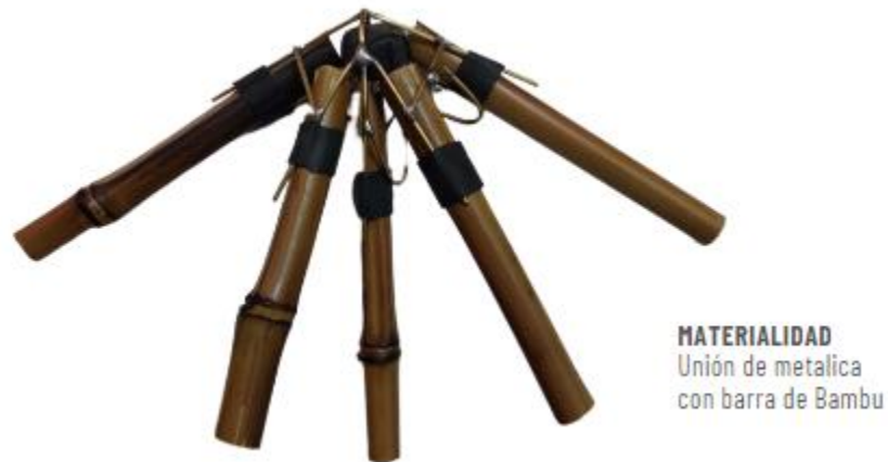
Imagen 20 Unión metálica con barra de Bambú
