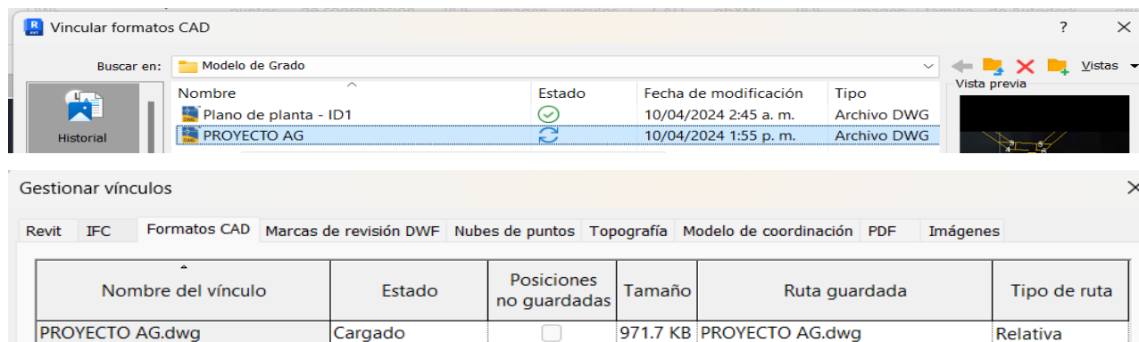
Figura 20 Interoperabilidad Civil 3D con Revit.
