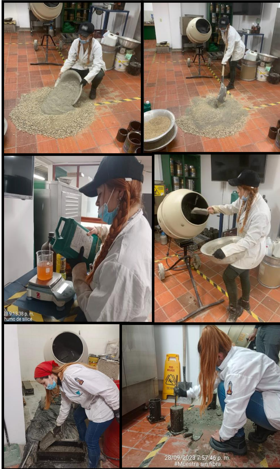
Figura 15 Proceso para realizar especímenes de concreto
