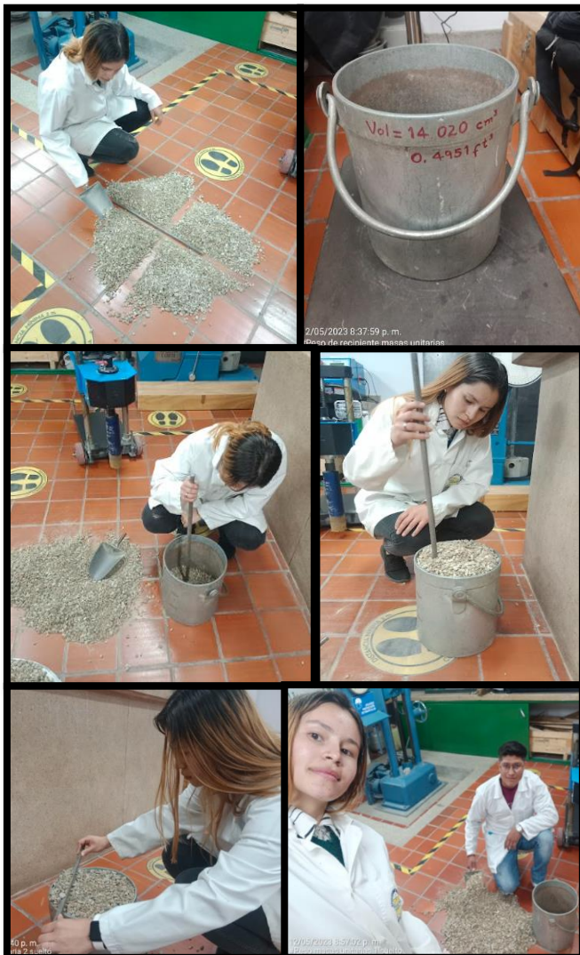
Figura 12 Procedimiento de masas unitarias del agregado
