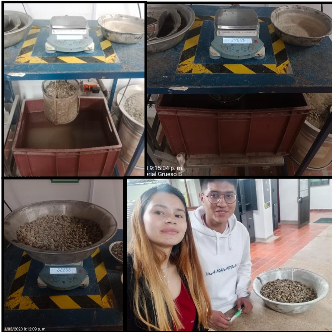
Figura 11 Procedimiento para el cálculo de la Absorción y densidad del agregado grueso
