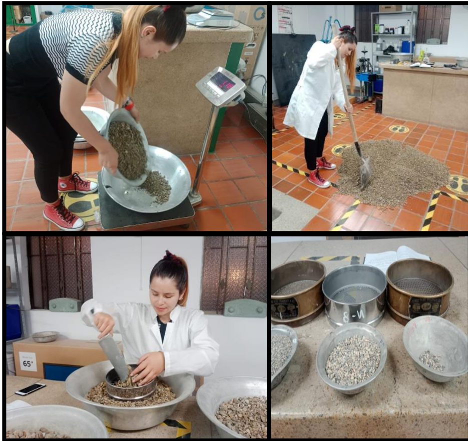
Figura 8 Procedimiento granulométrico agregado grueso
