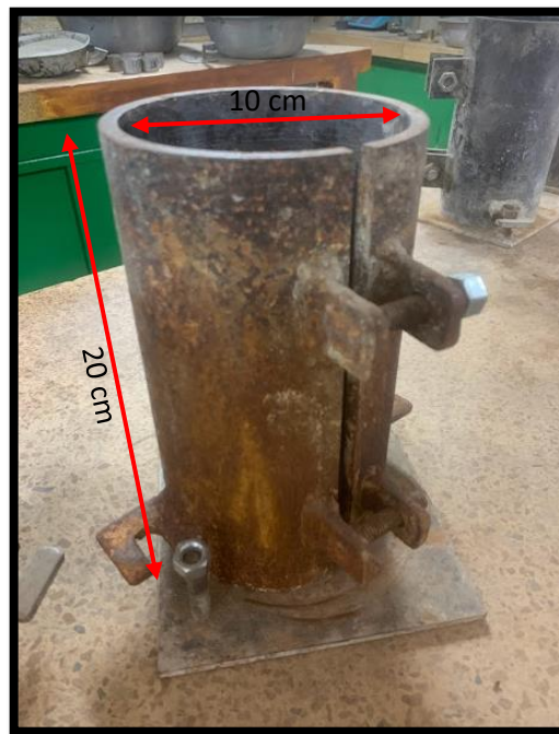
Figura 1 Camisa para especímenes de concreto (fuente propia)
