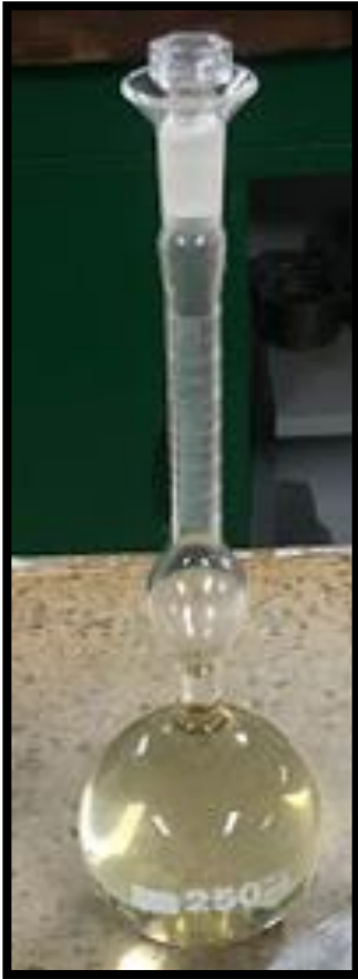
Figura 3 frasco de Le Chatelier usado para hallar la densidad del cemento.
