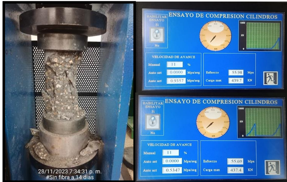
Figura 20 Fallo de cilindros 14 días
