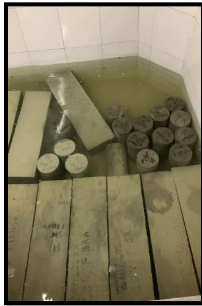
Figura 13 Curado de las probetas de concreto
