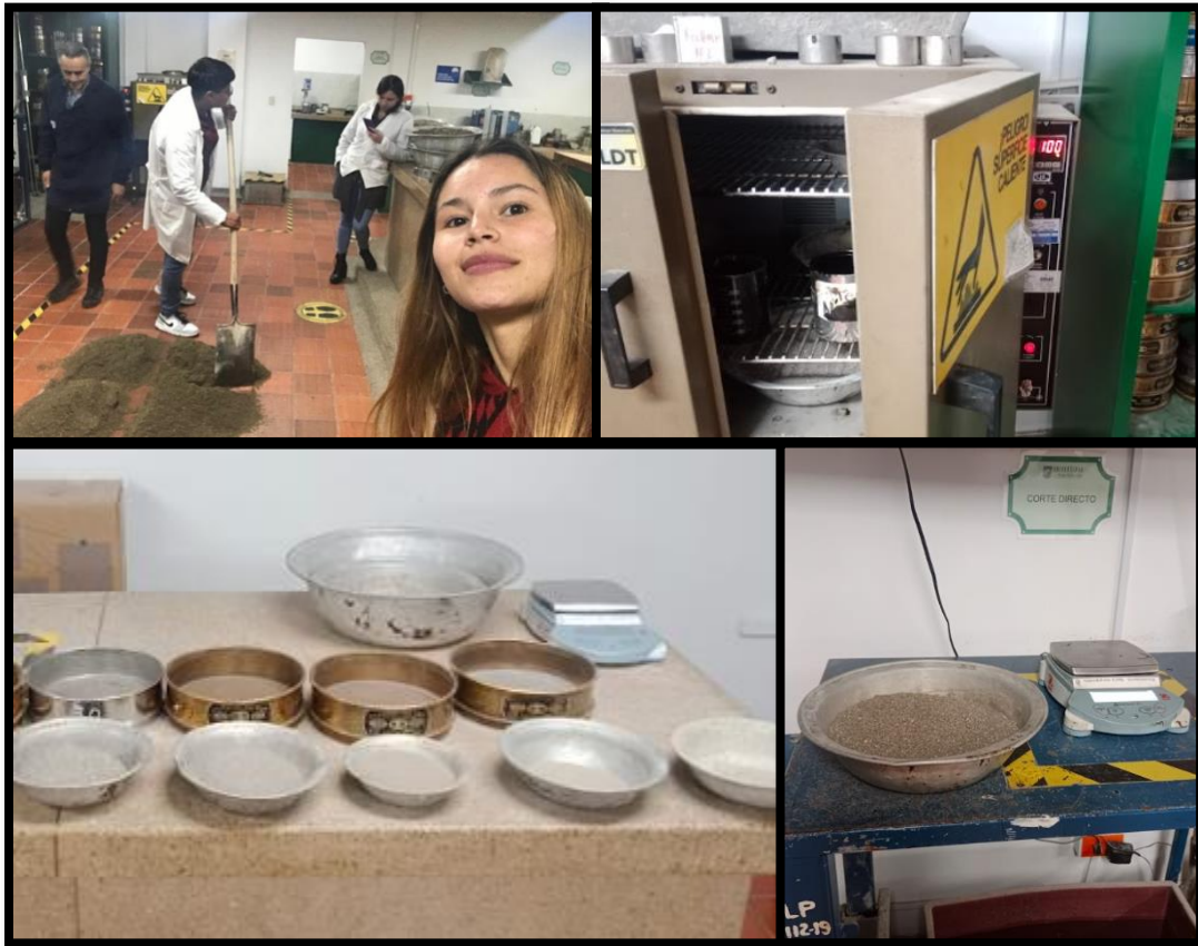
Figura 7 Procedimiento granulométrico agregado fino
