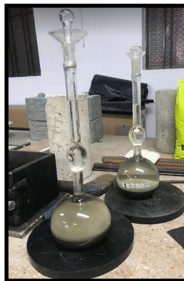
Figura 6 frascos de Le Chatelier utilizados para determinar promedio.
