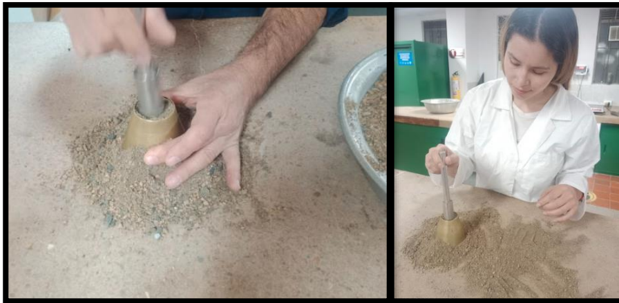
Figura 9 Ensayo de cono para la humedad superficial
