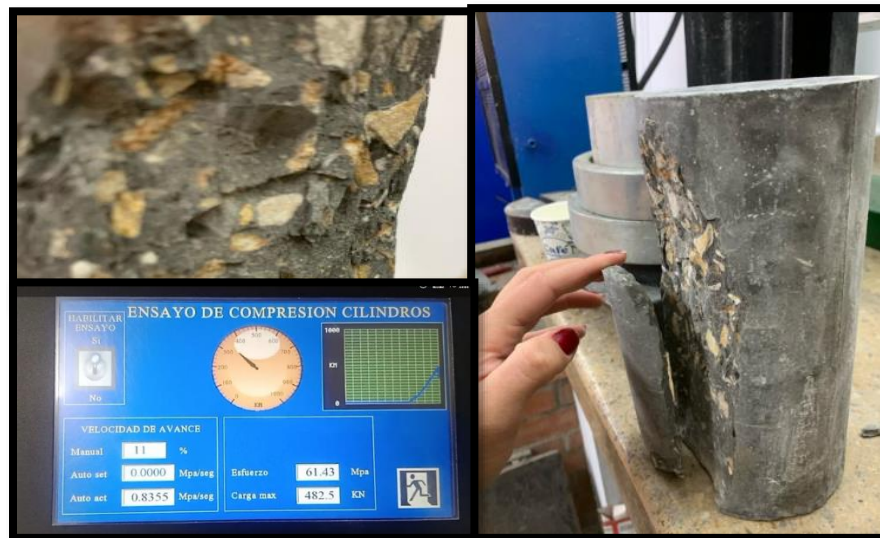
Figura 21 Fallo de cilindros 28 días
