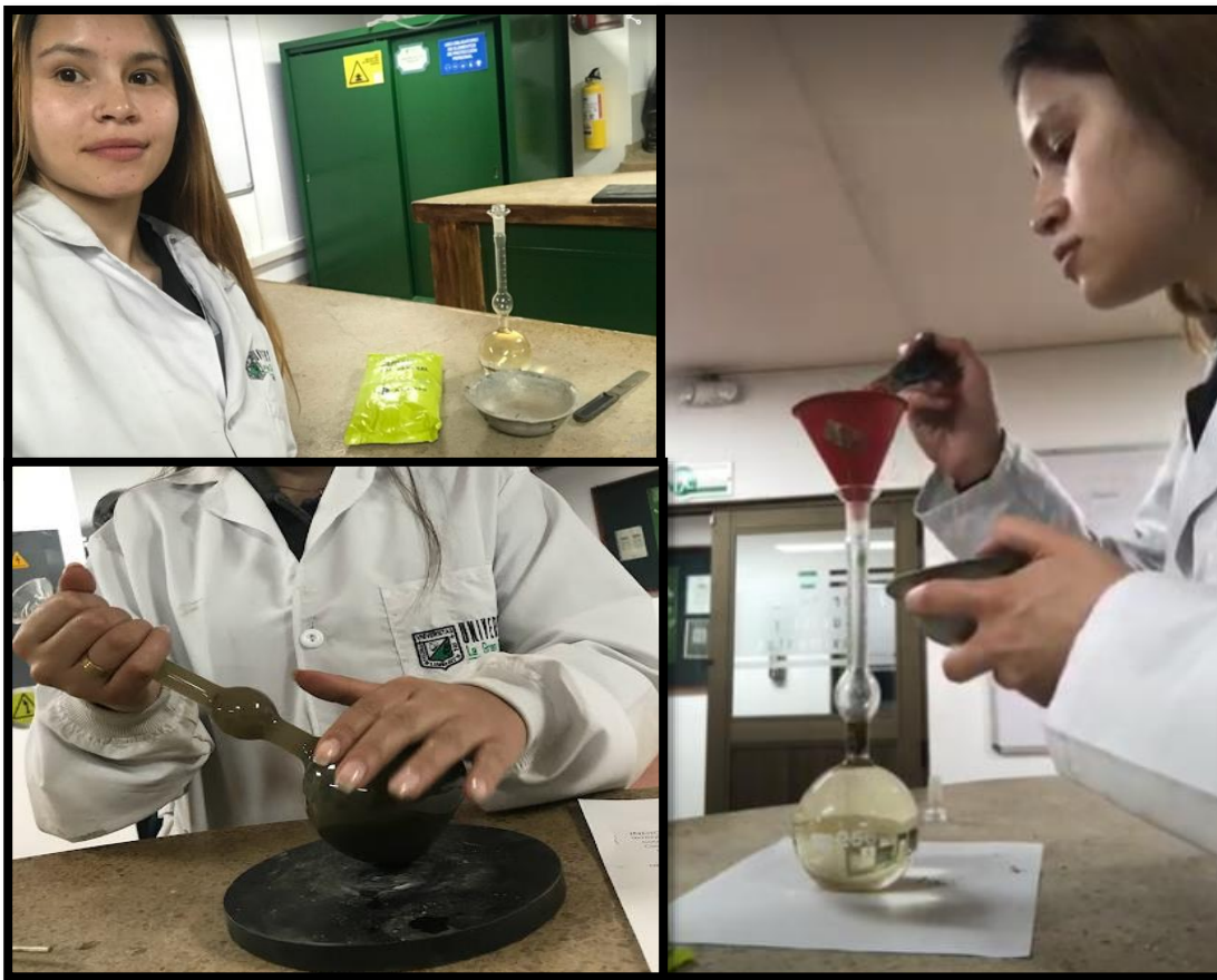
Figura 5 Procedimiento norma NTC 221 (Fuente propia)
