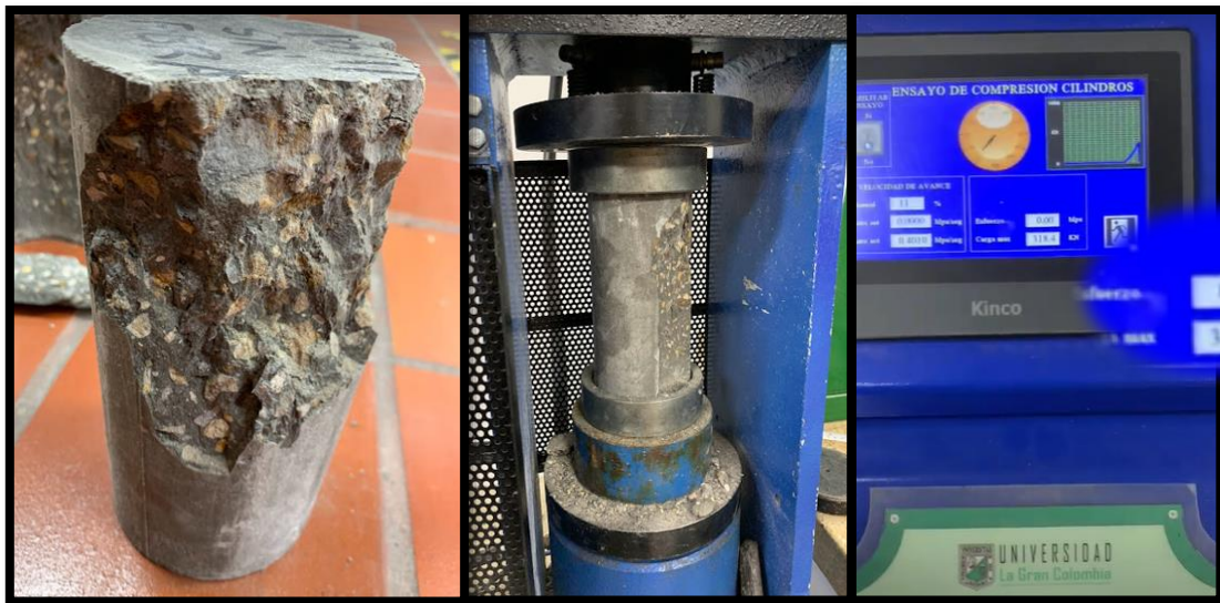
Figura 19 Fallo de cilindros 7 días
