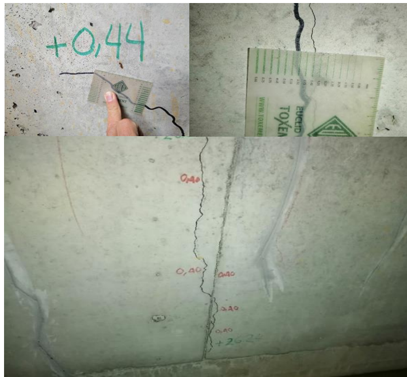
Ilustración 21 Identificación de fisuras y toma de ensayo de medición de profundidad de fisuras mediante ultrasonido
