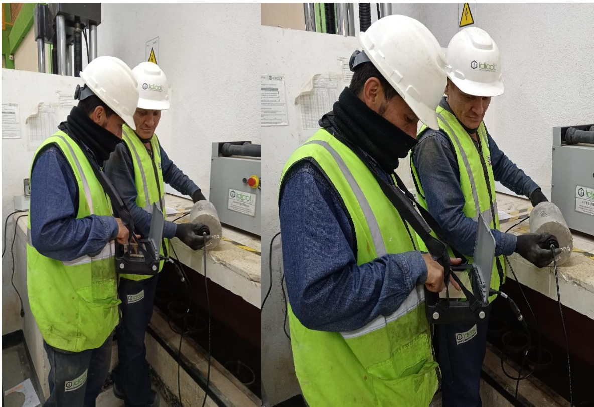
Ilustración 5 Ejecución de ensayo de ultrasonido en cilindro de 6"
