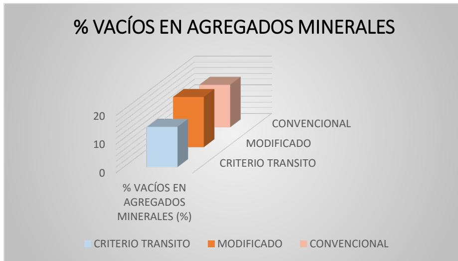
**% de Vacíos en Agregados Minerales (17.5%):** superamos ligeramente el valor mínimo, seguimos manteniéndonos dentro de un rango aceptable para garantizar la estabilidad de la mezcla.
