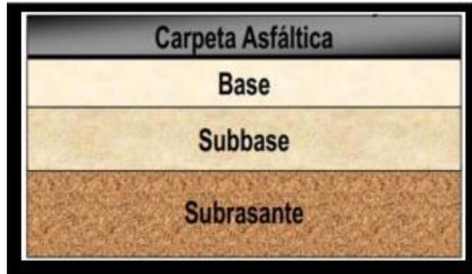
*Nota.* Estructura típica del pavimento flexible, Instructivo del proceso constructivo de una vía en pavimento flexible (Angie Ortiz 2017)
