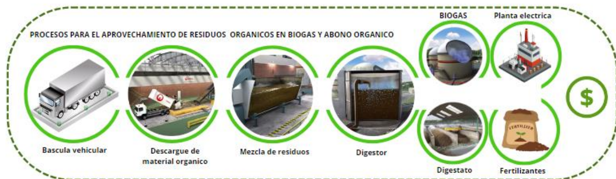
Figura 10 Diagrama de funcionamiento de planta de Biogás y Compostaje.
