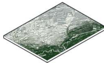
LINEAS TOPOGRÁFICAS Elevación cada 1 metro
