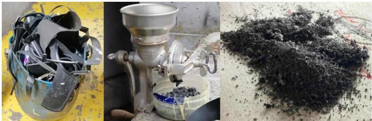
Figura 14 Proceso de transformación del textil de poliéster recubierto con PVC
