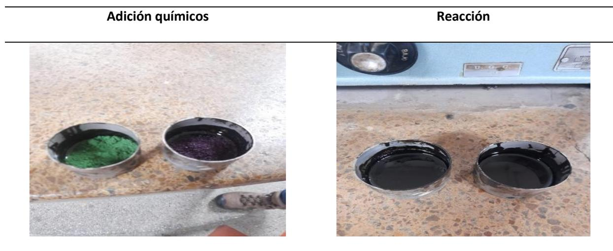
Esta figura es de fuente propia en la cual se aprecia la preparación y reacción del asfalto adicionado al 15 y 50 % con óxido de cromo III (componente de color verde) y óxido de cromo VI (componente de color morado escarchado).
