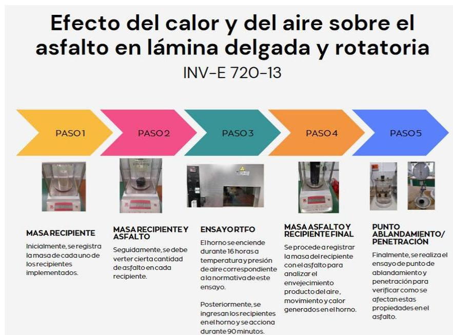
Esta figura es de fuente propia adaptada de la norma INV-E 720-13 del INVIAS, donde se puede apreciar el procedimiento necesario para realizar el ensayo del efecto del calor y del aire sobre el asfalto en lamina delgada y rotatoria (RTFO).
