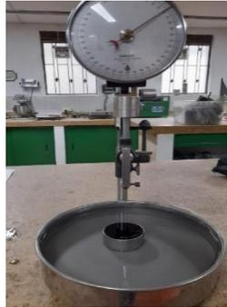
La presente figura es de fuente propia, por medio de la cual se puede observar el instante de la penetración de la aguja en el asfalto.
