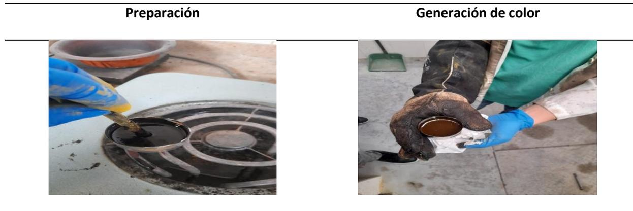
Esta figura es de fuente propia en la cual se describe la preparación y la generación de color del asfalto al adicionar óxido férrico al 80%.
