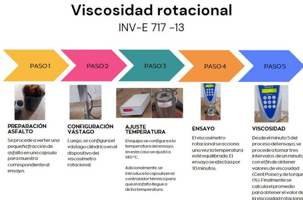
Esta figura es de fuente propia siguiendo los parámetros de la norma INV-E 717-13 del INVIAS, donde se consigna el procedimiento necesario para realizar el ensayo de viscosidad rotacional.
