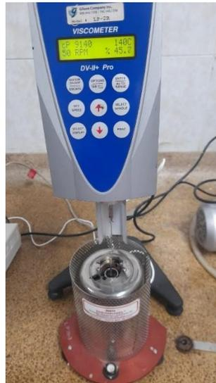
La figura 19 es de fuente propia, donde se evidencia la operación del ensayo de viscosidad rotacional.
