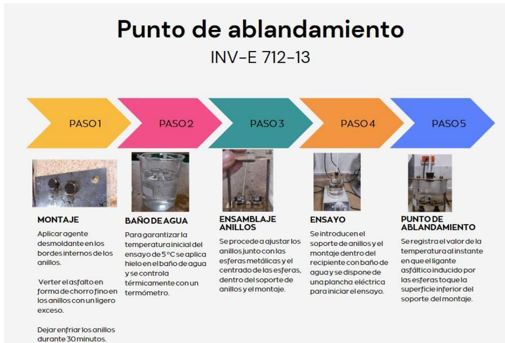
La presente figura es de fuente propia adaptada de forma de ilustración de la norma INV-E 712-13 del INVIAS, donde se puede apreciar el procedimiento requerido para ejecutar este ensayo.
