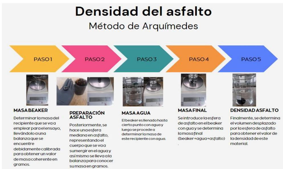
La presente figura es de fuente propia en la cual se puede apreciar el procedimiento necesario para realizar el ensayo de densidad del asfalto por el método de Arquímedes.
