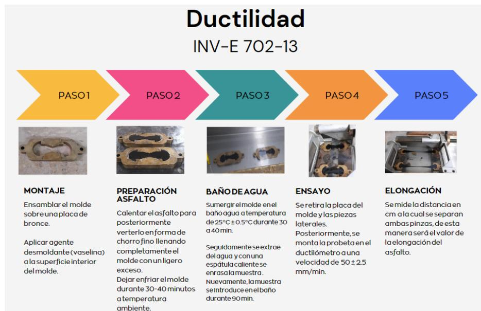
La presente figura es de fuente propia adaptada de forma de ilustración de la norma INV-E 702-13 del INVIAS, donde se puede apreciar el procedimiento necesario para realizar el ensayo de ductilidad desde el montaje de las probetas hasta la elongación de estas mismas.
