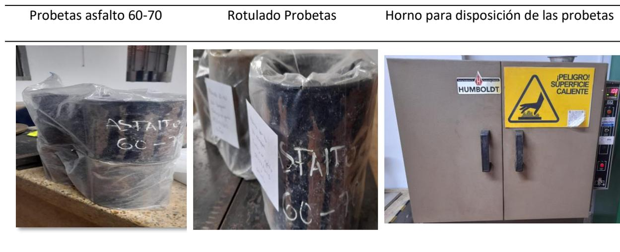
Esta figura es de fuente propia, donde se puede apreciar las probetas del producto bituminoso, con su respectivo rotulado y el horno implementado para la disposición de estas.
