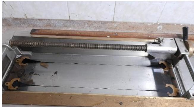
La presente figura es de fuente propia en la cual se evidencia la elongación de las probetas del asfalto 60-70.
