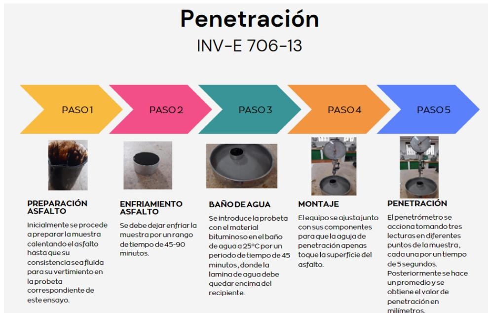
Esta ilustración es de fuente propia adaptada de la norma INV-E 706-13 del INVIAS, donde se puede evidenciar el proceso mediante el cual se desarrolla el ensayo de penetración.
