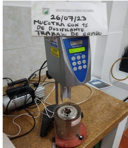
Figura 5. “ Ensayo de Viscosidad Rotacional de las Mezclas Asfálticas ”
