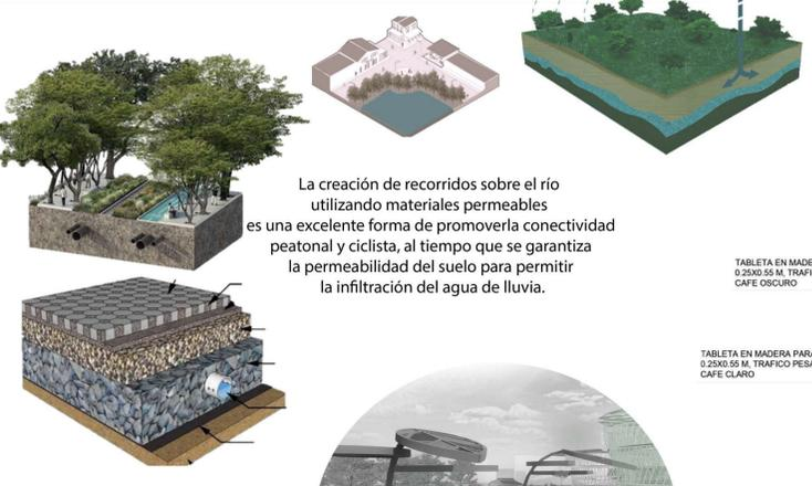
La creación de recorridos sobre el río utilizando materiales permeables es una excelente forma de promover la conectividad peatonal y ciclista, al tiempo que se garantiza la permeabilidad del suelo para permitir la infiltración del agua de lluvia.
