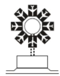
Aunque el concepto de espigón es el que puede alojar mas aeronaves al mismo tiempo, se selecciono el concepto lineal debido a la restricción predial, y la geometría del área con posibilidad de uso, la cual es alargada pero no tiene el ancho suficiente para acomodar aeronaves en espigones. Las restricciones prediales se dan por las pendientes pronunciadas y zonas de conservación presentes en la zona.
