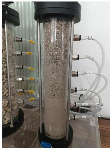
Se carga la base con agua manteniendo la bomba sumergida, para obtener una mejor visión en los picnómetros se agrega un colorante de comidas azul.
