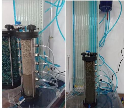
El material es sometido a una carga hidráulica hasta que esta sumergida por completo y se estabilice los niveles en el tablero.
