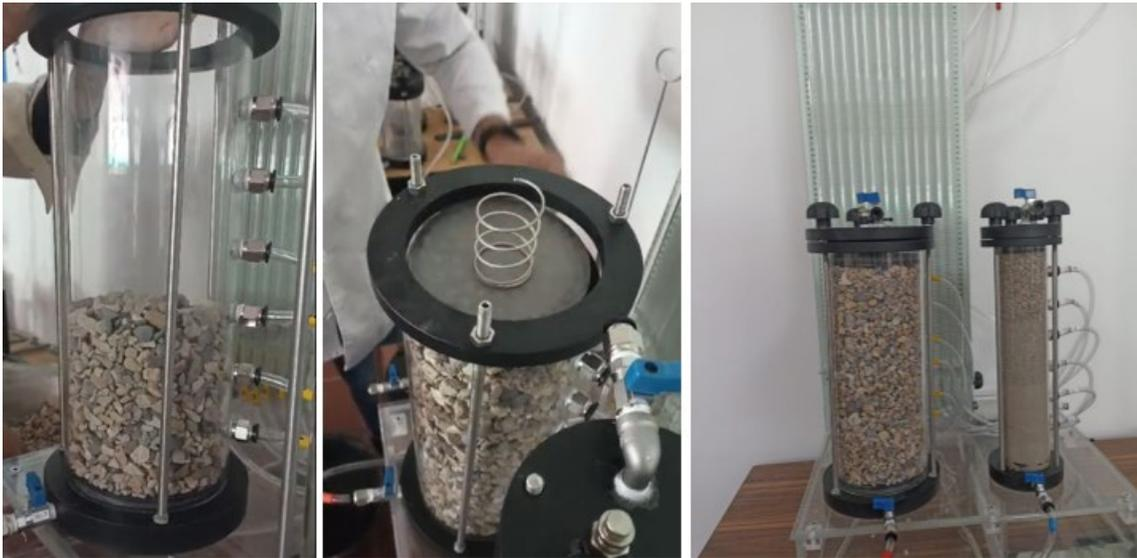
Se lleva el material a una altura de aproximadamente 3 cm del borde, se coloca el caucho, la piedra porosa, luego el resorte, la otra tapa y se sella con las perillas asegurando que no haya fugas.
