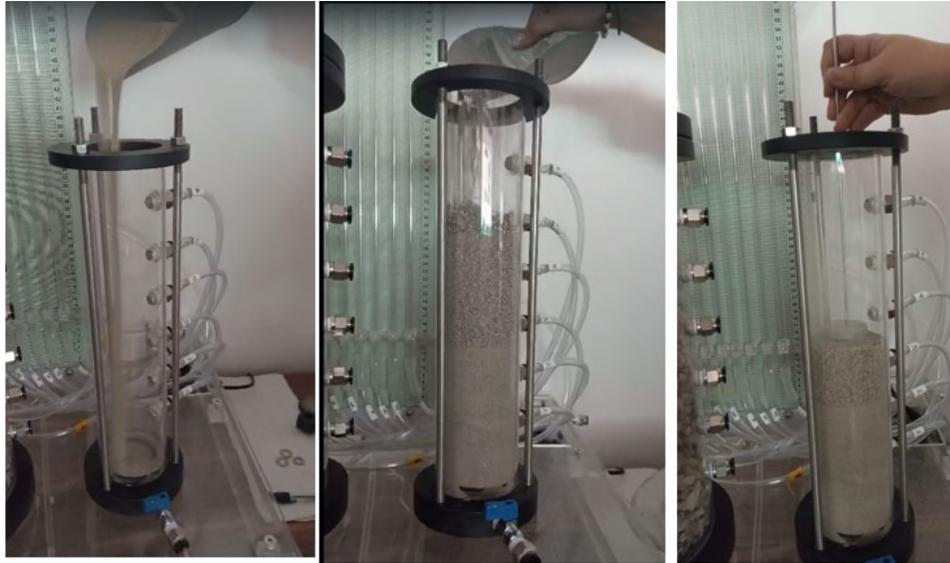
Una vez se compactaron las 3 capas del material granular y se han puesto las piedras porosas, el caucho y el resorte que no permite un cambio en la compactación del material, se somete la muestra a una carga hidráulica.
