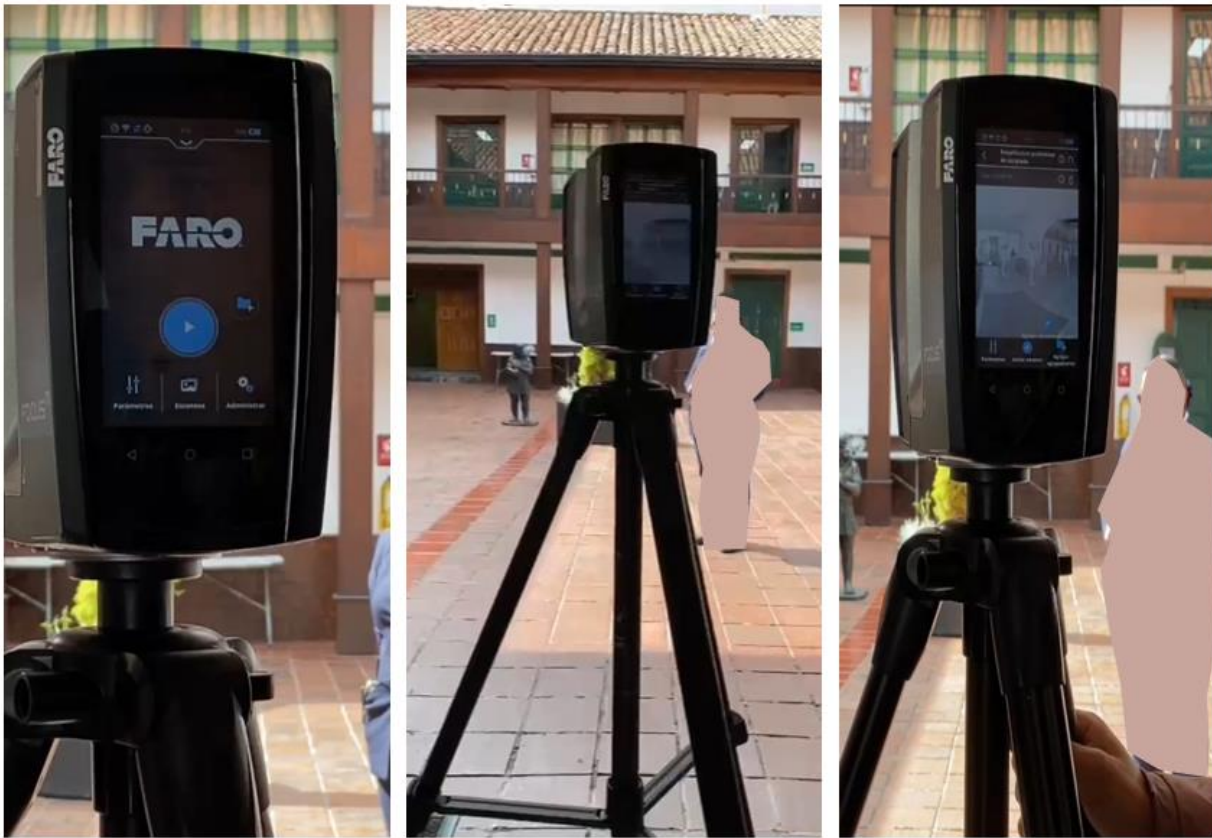
Nota. Herramienta implementada para el levantamiento realizado – Faro Scanner. Elaboración propia.
