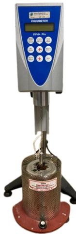
*Nota.* La figura representa la imagen del equipo Viscosímetro Brookfield (Rotacional).
