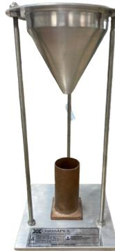
*Nota.* La figura representa la imagen del soporte del embudo el cual hace parte del equipo para determinar el contenido de vacíos de los agregados finos no compactados. “Elaboración propia”, equipo de laboratorio Facultad de Ingenierías, Universidad la Gran Colombia
