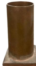
*Nota.* La figura representa la imagen del recipiente cilíndrico el cual hace parte del equipo para determinar el contenido de vacíos de los agregados finos no compactados. "Elaboración propia", equipo de laboratorio Facultad de Ingenierías, Universidad la Gran Colombia
