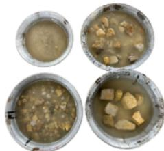
Se determina la masa de cada fracción de la muestra en la balanza de acuerdo a la tabla 2
