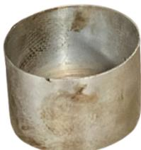
*Nota.* La figura representa la imagen del recipiente para la muestra el cual hace parte del equipo de Penetración.
