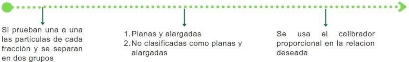
**Ensayo de partículas planas y alargadas:** Se ajusta la abertura más grande del dispositivo a la longitud máxima de la partícula, se considera que la partícula es plana y alargada si al ser colocada por su espesor máximo atraviesa la abertura más pequeña.
