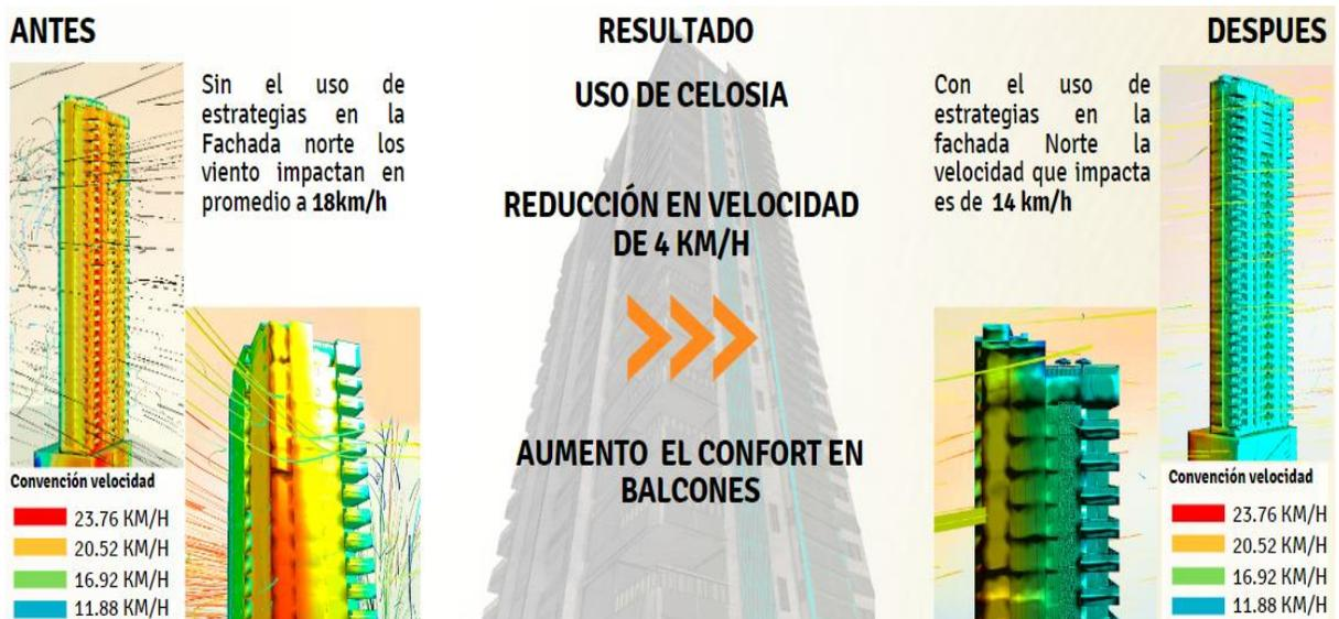
*Nota.* Antes y después de la integración de la propuesta de fachada ventilada con el uso de celosía en PVC en el programa Flow design. Elaboración propia
