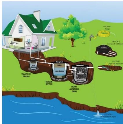
*Nota:* el esquema presentado nos muestra el funcionamiento del pozo anaerobio. Tomado de “Rotoplas”. 2022. (<https://rotoplas.com.ar/beneficios-de-un-biodigestor-vs-una-camara-septica/>).
