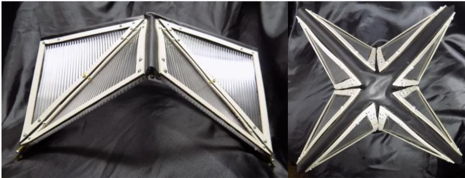
*Nota.* Modelo constructivo de plegadura dinámica, se aplican los materiales propuestos mostrando cómo se monta el módulo y cumple con los requisitos propuestos. Elaboración propia.
