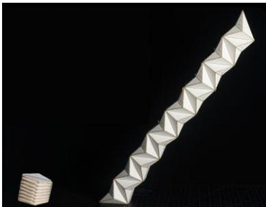
*Nota.* Propuesta de neumáticas desplegables basadas en plegaduras y origami, demostrando capacidad de plegabilidad y transportabilidad. Tomado de “Multistable inflatable origami structures at the metre scale” D. Melancon et al. 2021. (<https://doi.org/10.1038/s41586-021-03407-4>)
