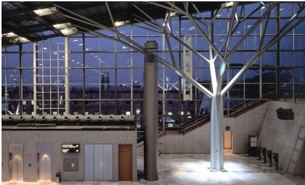
*Nota.* Aeropuerto de Stuttgart, 2004, arquitecto Meinhard von Gerkan. Estructura de cubierta del terminal con geometría arboriforme. Tomado de "Stuttgart Airport" gmp. s.f. (<https://www.gmp.de/en/projects/548/stuttgart-airport>)
