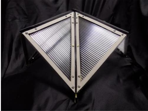
*Nota.* Uso de páneles de cerramiento en lámina de policarbonato. Elaboración propia.
