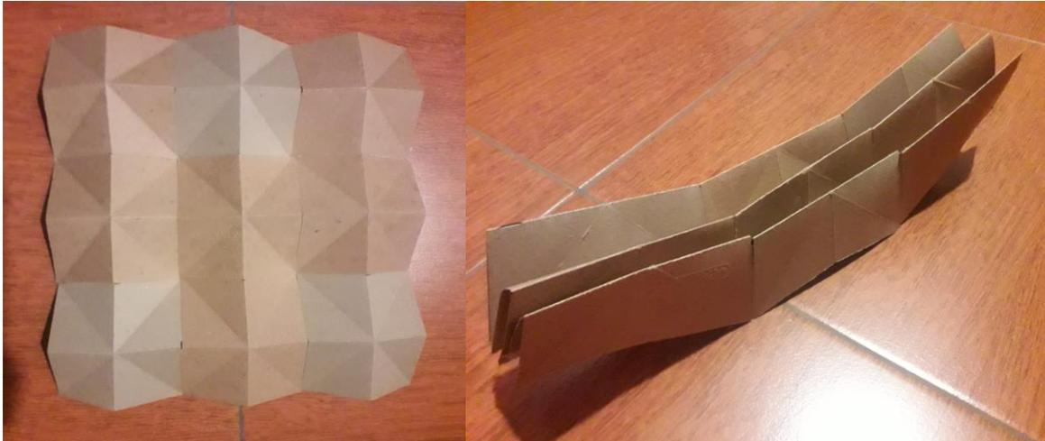
*Nota.* La misma red de módulos piramidales se pliega en sentido contrario en cada dirección, generando lo que se requería, la red aumenta de dimensión en un sentido y se reduce en el otro, dando viabilidad al uso de esta red para este tipo de sistema de tijeras. Elaboración propia.
