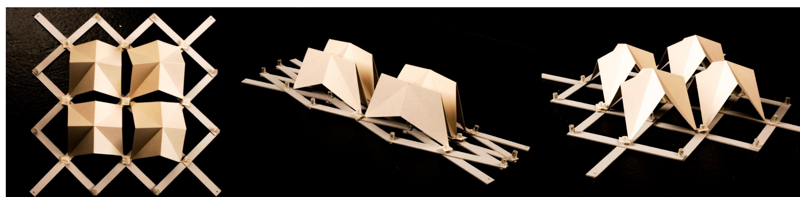
Modelo de agrupación en plano de tijera con cerramiento de plegadura piramidal. Elaboración propia.
