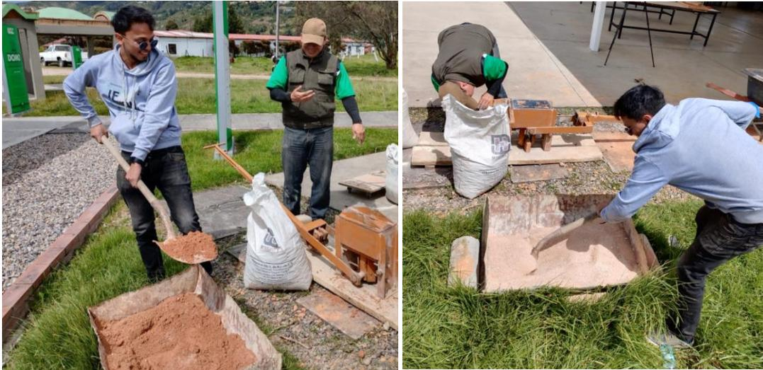
*Prueba de caída.* Esta se realiza para ver la cohesión y observar el material de suelo que se va a tomar y se encuentra mezclado para la elaboración del BTC.
