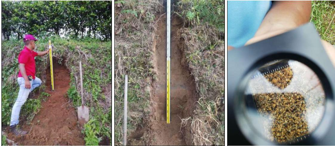
Figuras 19-21. Proceso de verificación de información sobre el espesor de la ceniza en campo.
