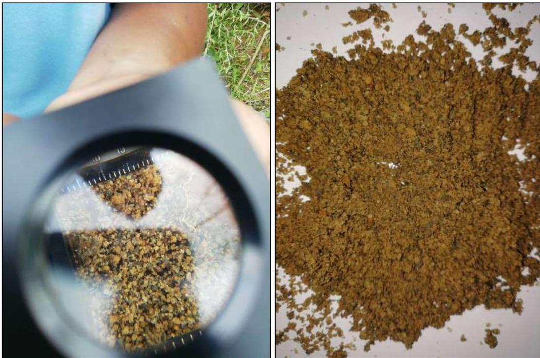
Figura 25 (Izq) y 26 (Der). Material perteneciente a un flujo piroclástico con verificación de tamaño granulométrico inferior a 2 milímetros (SGM. 2020) - Der: Material meteorizado y mezclado con material orgánico y de arcillas debido a la infiltración de las lluvias.
