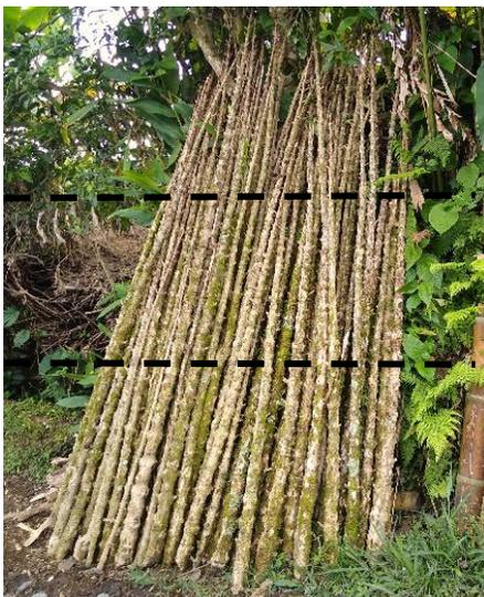
*Nota.* En la fotografía se identifican los tallos de 2.30 metros después del secado, según la línea punteada se realizan los cortes. Elaboración propia.
