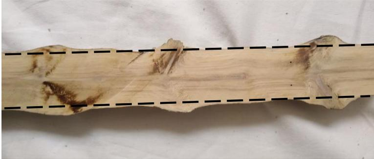
*Nota.* La fotografía revela el corte de láminas y residuos de nudos, del mismo modo que se realizó el alistamiento para la estructura principal, se realizará este. Elaboración propia.
