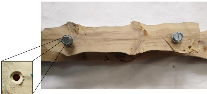
*Nota.* En la fotografía se detalla el tipo de perforación realizada para los tornillos. Elaboración propia.
