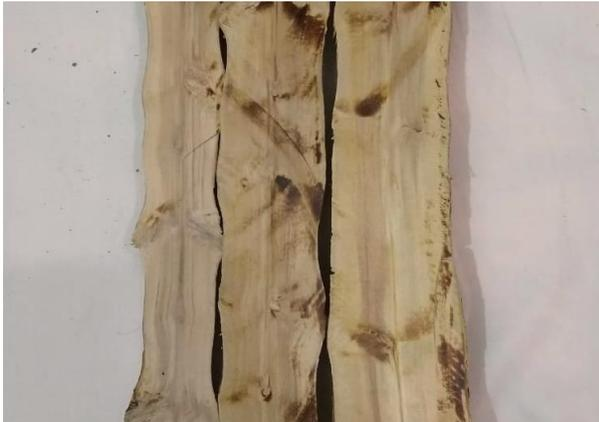
*Nota.* En la fotografía se identifica el corte final transversal de tallos para entramado de panel, por tallo salen tres cortes transversales. Elaboración propia.
