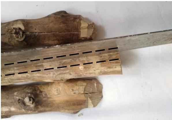
*Nota.* En la fotografía se identifica el trazo vertical en el tallo, primeramente se realiza un trazado horizontal para continuar con el vertical siguiendo la referencia horizontal. Elaboración propia.
