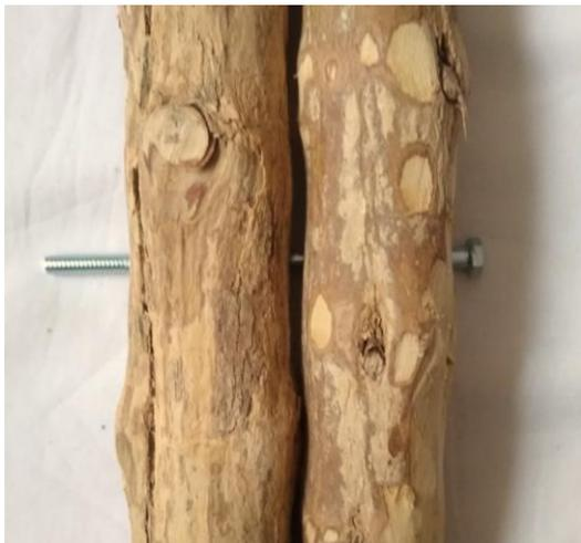
*Nota.* La fotografía se expone un ejemplo para medir los tornillos antes de la realización del panel, debe atravesar los tallos. Elaboración propia.
