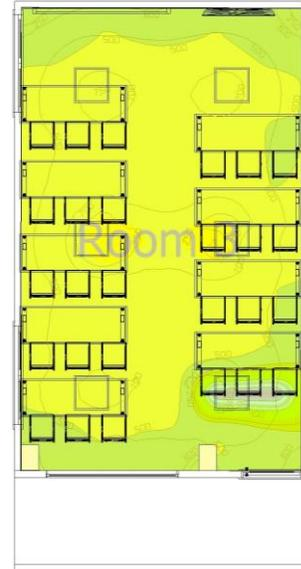
Figura 11. Malla de cálculo en planta programa Dialux
