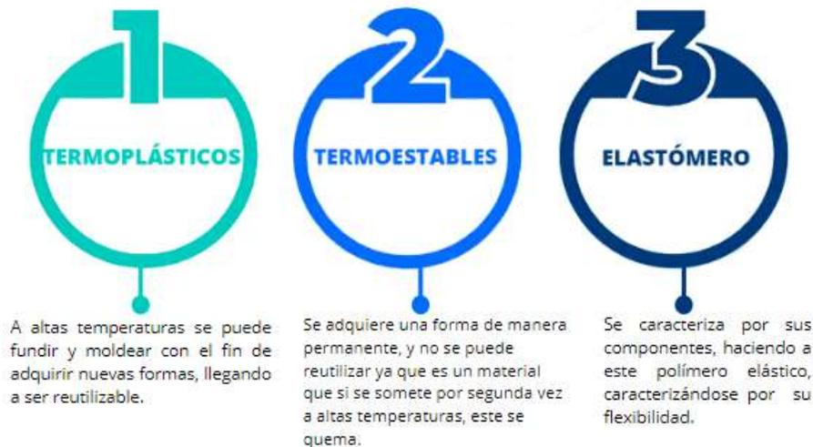
*NOTA. En la figura se evidencia los tipos de plásticos que existen y su caracterización. (fuente: elaboración propia).*
