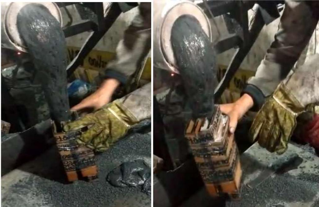
*NOTA. En la fotografía se evidencia el proceso de la primera inyección plástica para la fabricación del bloque, en este proceso se tuvo en cuenta el PP5 color negro y el molde del bloque elaborado en MDF. fuente: elaboración propia).*
