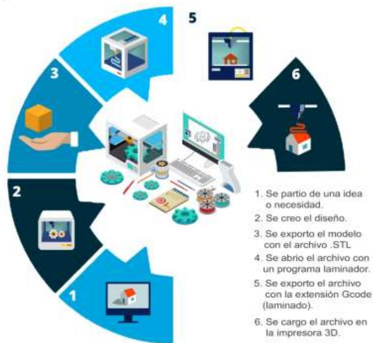
NOTA. La figura representa el proceso metodológico de la impresión 3D para la elaboración de los prototipos de bloques. (fuente: elaboración propia).
