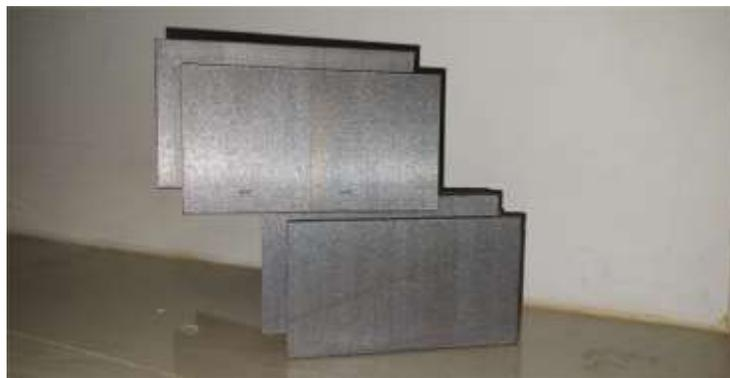
*NOTA. La figura representa el bloque plástico impreso en 3D con filamento ABS color gris perlado, como prototipo de avance y proceso de determinante de diseño y funcionalidad fabricación, (fuente: elaboración propia).*
