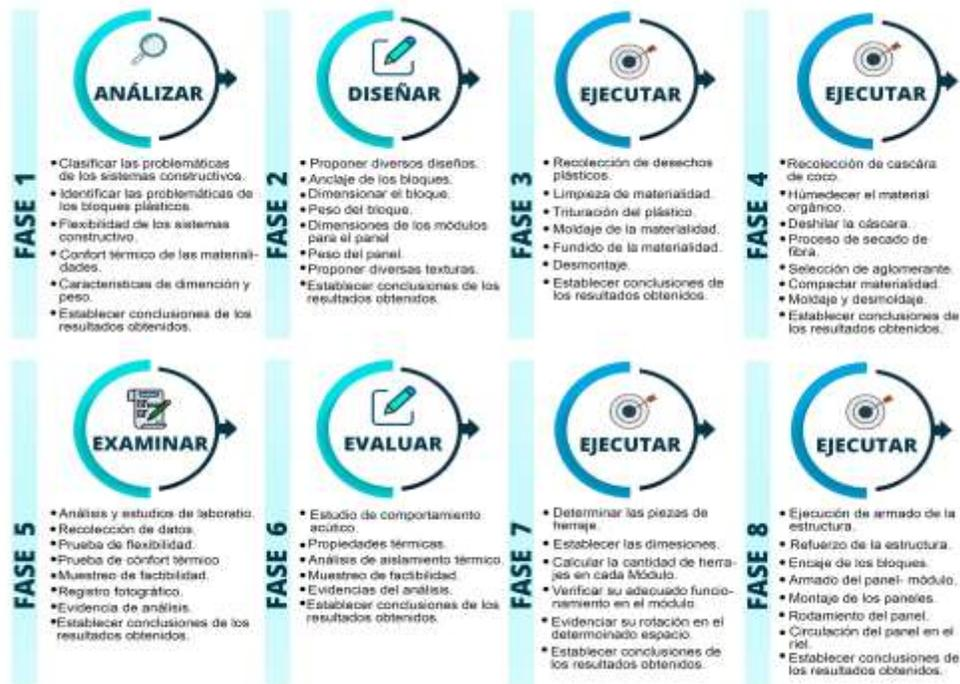
*NOTA. La figura representa el proceso metodológico del bloque plástico, partiendo principalmente desde un previo análisis y finalizando en la ejecución del armado del panel en un determinado espacio. (fuente: elaboración propia).*
