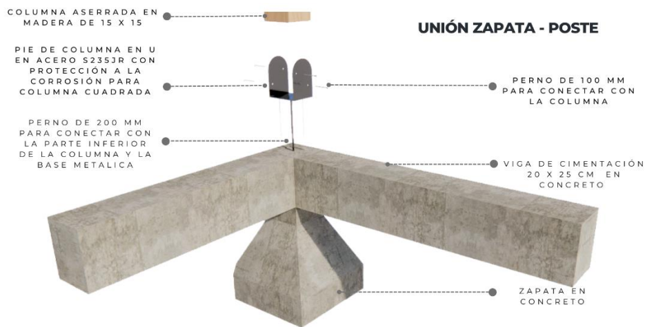
Unión estructural de poste, viga y zapata
