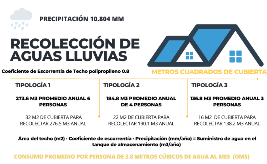
Recolección de aguas lluvias, metros cuadrados de cubierta necesarios por tipología de vivienda
