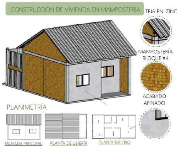
figura 42 Vivienda en mampostería
