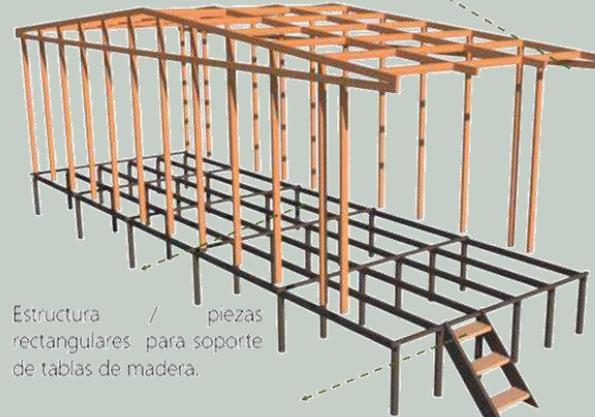
Estructura / piezas rectangulares para soporte de tablas de madera.
