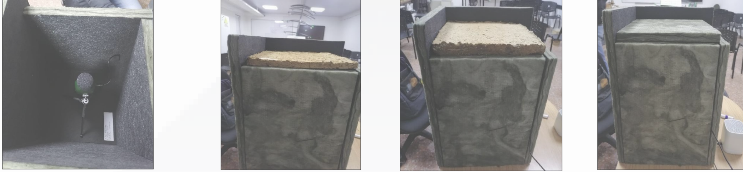
CAJA CREADA CON BLACK THEATER SONÓMETRO EN SU INTERIOR PRUEBA PANEL 30X30 2CM PRUEBA PANEL 30X30 3CM PRUEBA PANEL 30X30 2 CM BLACK THEATER
