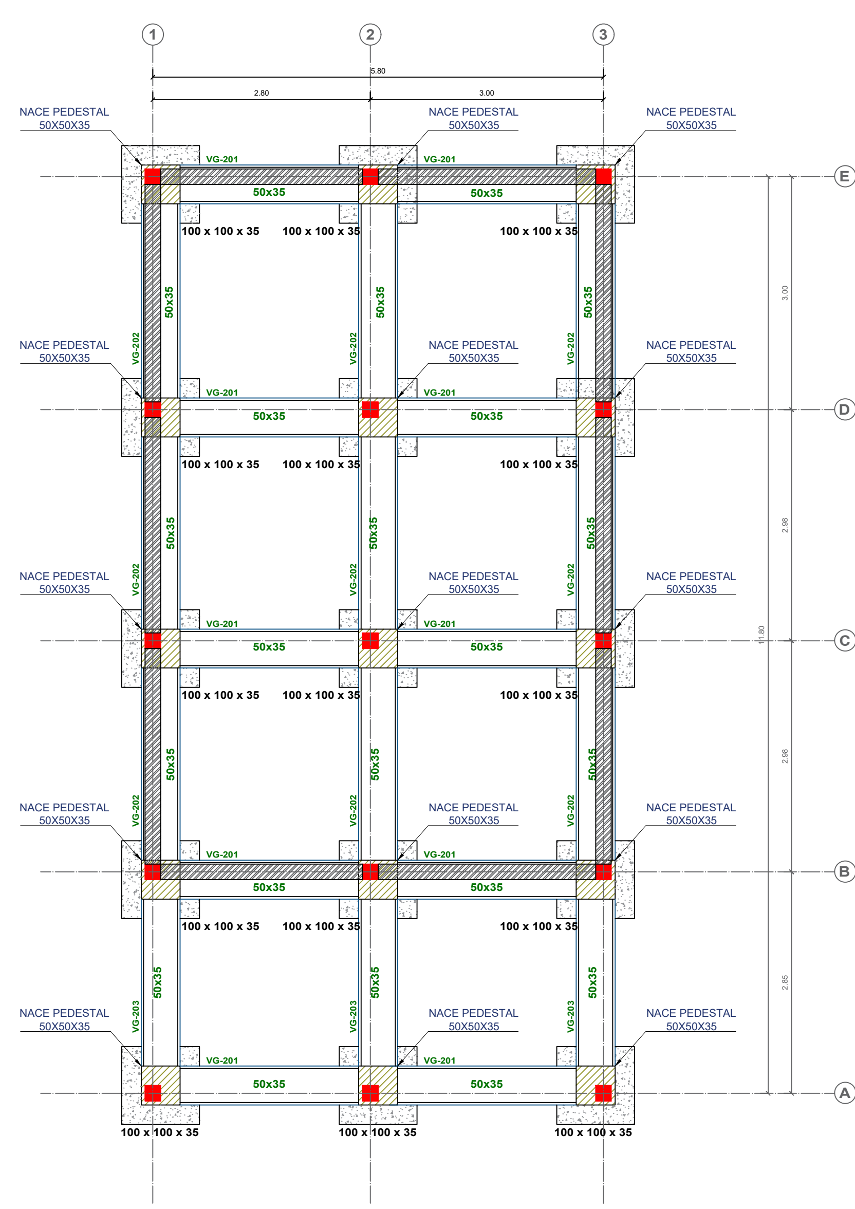
P30 PLANTA CIMENTACIÓN Escala 1:50
