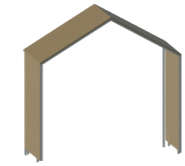
muros y cubieta de madera OBS 1 unidad.
