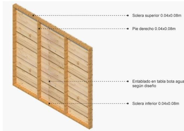
*Nota.* Detalle del muro donde se destaca la composición por capas. Elaboración propia
