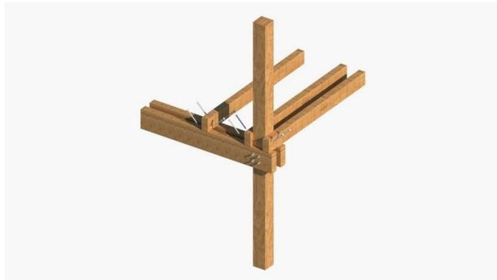
*Nota.* Detalle de uniones viga y columna. Elaboración propia**Figura 35.***Anclaje pilares*
