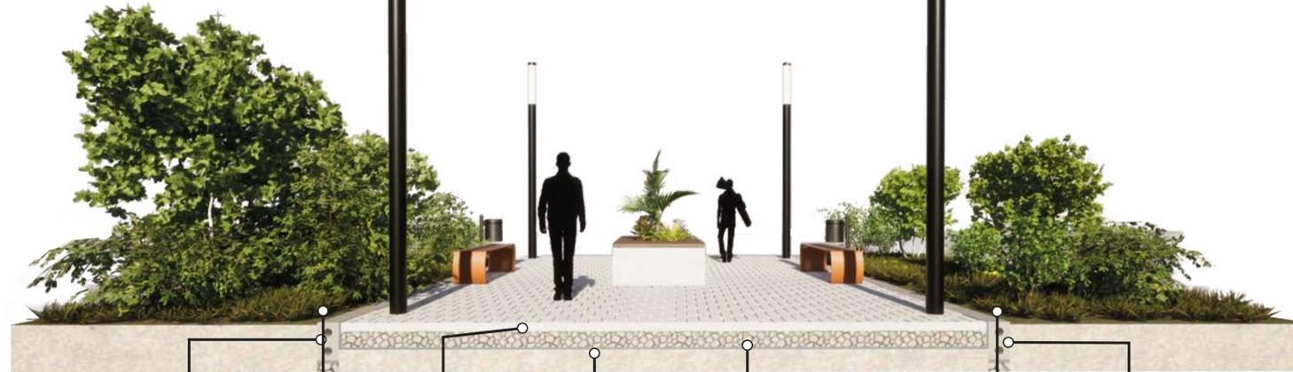
SARDINEL MATERIAL DE RELLENO ADOQUIN DE 20cm x 10cm. MANTO ASFALTICO ANTIRAIZ. MATERIAL DE RELLENO MATERIAL DE RELLENO SARDINEL **C1** DETALLE SENDERO TIPO 1
