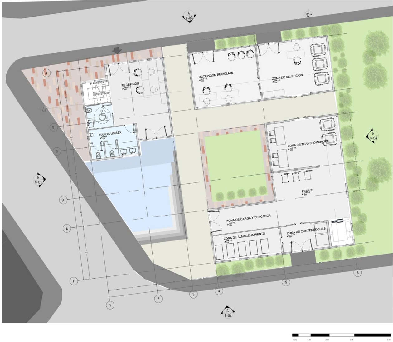
Planta primer piso centro de reciclaje
