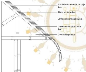
D7 Cubierta tipo sandwich Esc 1:10
