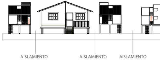
*Nota:* Esquema donde se representa los aislamientos realizados entre las viviendas con propósitos bioclimáticos. Adaptado de AutoCAD + Illustrator. 2022.
