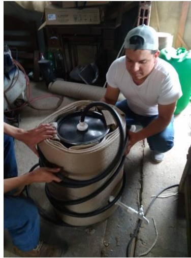
2. Tanque con aislamiento y sistema de mangueras
