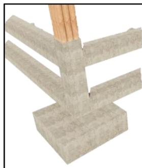
*Nota.* Detalle cimentacio unión zapatas y vigas. Elaboración propia
