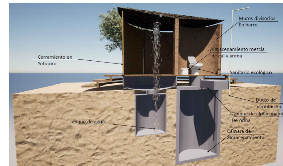
D-003 SISTEMA EN SECO DETALLES LOD 350
