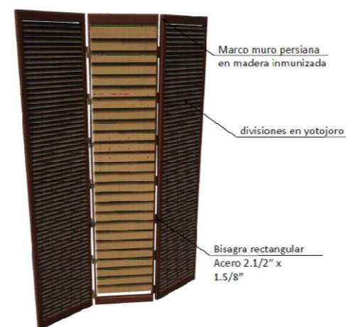
D-004 MURO TIPO PERSIANA DETALLES LOD 350
