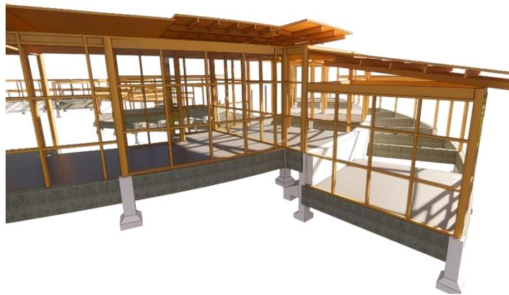
*Figura 91. Corte 3D estructural. Elaboración propia.*
