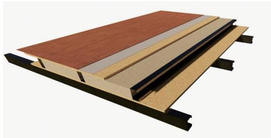
Nota. La figura muestra cada uno de los materiales que conforman el panel de contrapiso con subestructura al interior del mismo, apoyado sobre viguetas.
