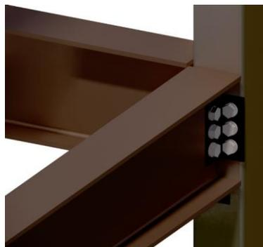
*Nota.* La figura muestra el anclaje por medio de una pletina y la ménsula para asegurar el ajuste de la estructura de los módulos. Elaboración propia.
